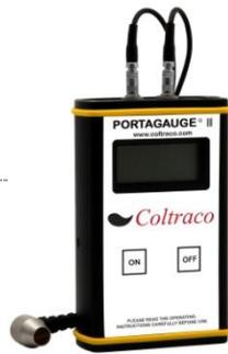
Простейший толщиномер, построенный по принципу одиночного отраженного импульса, для руководителей эксплуатационных служб и т.п. Является идеальным средством контроля большинства стальных конструкций, трубопроводов, корпусных элементов и коррозии на борту судна. Карманный прибор с полной трехлетней гарантией представляет собой надежное и универсальное решение.
